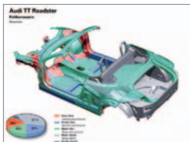
Audi TT Roadster mit Karosserie in Al-Stahl-Mischbauweise
